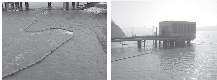
Figura 4.9 Estrutura da barreira flutuante testada no sistema Rio Grande/SP (RIVELINO et al, 2003).
