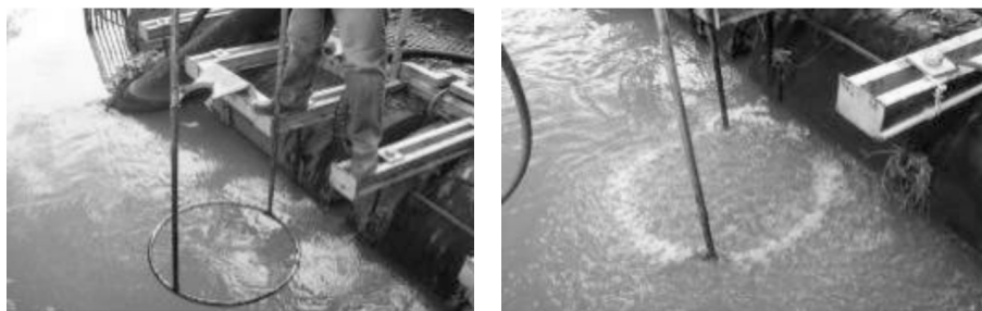
Figura 4.12 Estrutura do aparato de injeção de ar construído pela COPASA.
