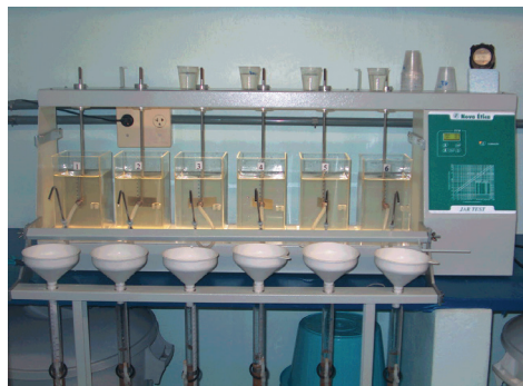
Figura 7.2 Foto ilustrando o equipamento de jarteste com filtros de laboratório
